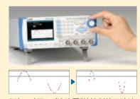
例如, 对于CF(波峰因数)控制的正弦波, 其波形的波峰因数可在1.41到10.00之 间设定。可以边确认波形, 边转动手动 旋钮(Modifier Knob)简单地改变参数(波 峰因数)。随后,其频率、振幅、振荡模 式等就可以用与标准波形同样的方式 来操作。\*1
